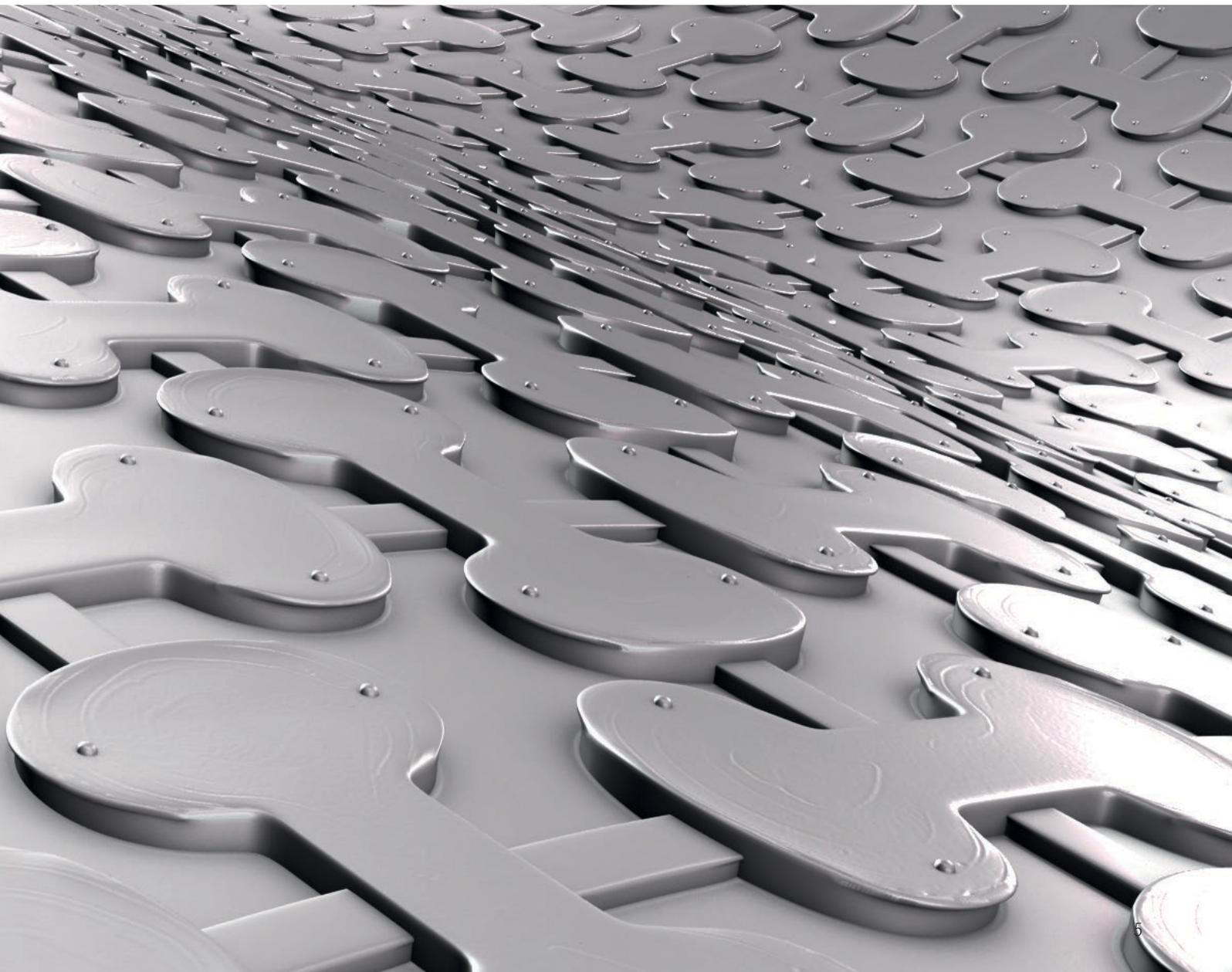
L'IndorTec® FLEXBONE-2E est posée en mode flottant, c'est-à-dire sans fixation au support par mortier-colle. Le système assure à la fois une ventilation et une désolidarisation du revêtement et du support, et ce, de manière fiable et durable. L'armature que forme le treillis rend même son utilisation possible sur des supports à mauvais accrochage. En outre, la pose flottante réduit jusqu'à 50 % du temps de pose généralement nécessaire.
