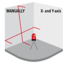
Laser de ligne avec 1 ligne rouge horizontale et 1 verticale. Nivellement pendulaire avec une précision de 2 mm/10 m et une portée de 50 m avec récepteur (en option).
