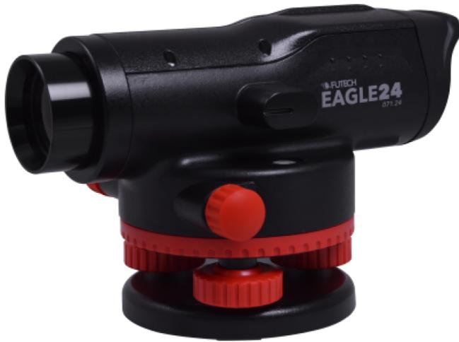
Optische kijker met een nauwkeurigheid van 2mm die 24 keer vergroot. De kijker heeft een zelfnivellerend bereik van 15°, magnetische demping en kan 360° draaien.
