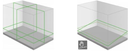
Kleine 3D Kruislijnlasers met 1 groene horizontale lijn rondom en 2 verticale lijnen rondom (= schietlood boven en onder + 4 hoeken van 90°). Pendelnivellering met 2mm/10m nauwkeurigheid en een bereik van 50m met ontvanger (optioneel). Li-Ion batterij met netstroomadapter/lader.
