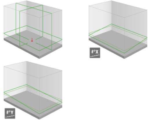
4 verticale + 4 horizontale groene laserlijnen van 50mW - Bereik 2 x 200m - Stof- en waterdichtheid IP66 - Nauwkeurigheid 1mm/10m - Dubbele helling, manueel of elektronisch of digitaal (via afstandsbediening) - Tiltfunctie
