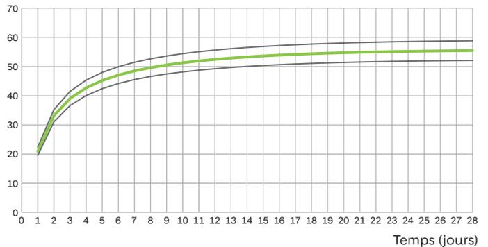
La figure donne l'évolution de la résistance à la compression sur cube de 150 mm d'arête d'un béton standard<sup>(3)</sup>, obtenue dans notre laboratoire, sur un béton à base du CEM II/A-LL 52,5 N (ng).
