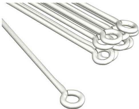
PlaGyp® R150/.. est un fil de suspension à œillet en acier pour la suspension de plafonds PlaGyp® et Vertebra destiné au parachèvement à sec. Le fil de suspension à œillet est produit suivant NBN EN 14195:2015 en acier thermozingué (Z100 suivant NBN EN 10346:2015) avec diamètre 4 mm et pourvu d'un œillet d'un diamètre intérieur de 7 mm.
