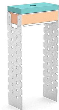
PlaGyp® PU60/125 dB est une suspente acoustique universelle pour profilés PlaGyp® PC60/27, laminée à froid suivant NBN EN 14195:2015, qui se compose d'acier thermozingué (Z100 suivant NBN EN 10346:2015), et une déconnexion acoustique avec sylo-elast.
